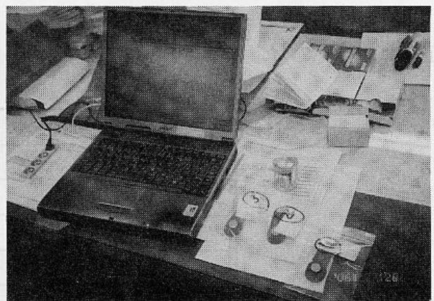
写真8 ボタン型温度センサからパソコンへの温度履歴の記録
