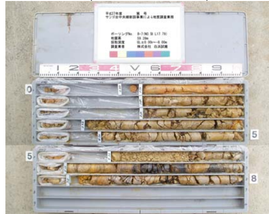
ボーリングコア写真 B-7 (GL±0.00m~-8.00m)
