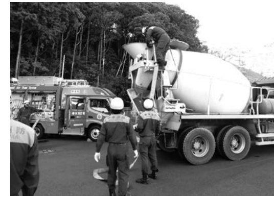
ポンプ車からミキサー車へ給水
