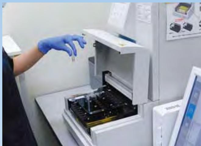
45分で検査ができるPCR検査機（検体セット中）
